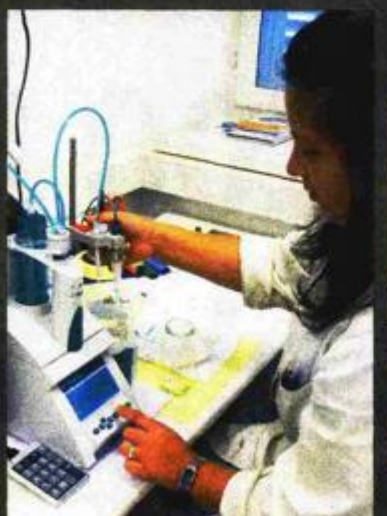
Mjerenje količine klorida pomoću potencijometrijskog tiratora
