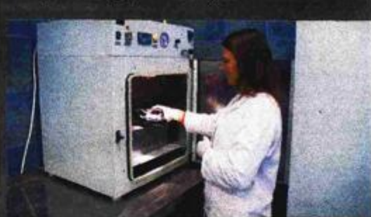
Konsolidacija drveta u vakuumskoj komori
